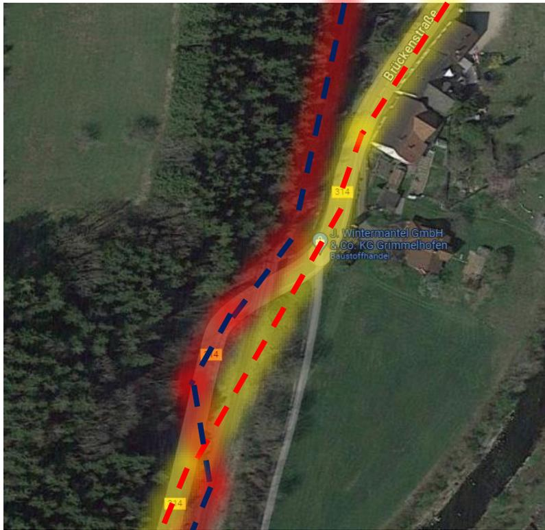
Entschärfung der Brückensituation bei Grimmelshofen. Begradigung der B314 und Verlegung des Sauschwänzlebahndamms um die B314 zu optimieren. Die Bahn wird genutzt kann aber mit dem Verlauf von 2 theoretischen Gleiswechseln in einem "S" über die B314 geführt werden.
