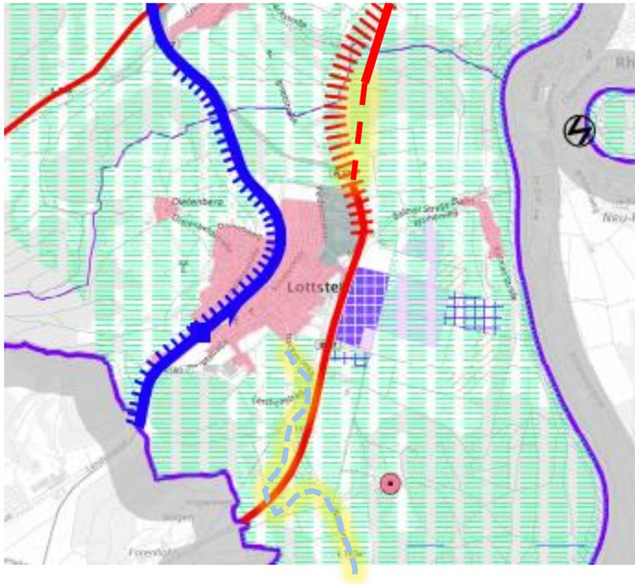
Planung der Umgehungsstrasse Jettetten auf Lottstetter Seite als tunnel unter dem Bergrücken Birret und Querung des Volkenbaches mit niedrigem Brückenbau.
